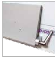
Teclado médico plegable integrado de fácil desinfección con touchpad con revestimiento antibacteriano. Disponibles con teclado bajo lámina, de silicona y de cristal.
