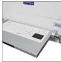
Teclado médico plegable integrado de fácil desinfección con touchpad con revestimiento antibacteriano. Disponibles con teclado bajo lámina, de silicona y de cristal.
